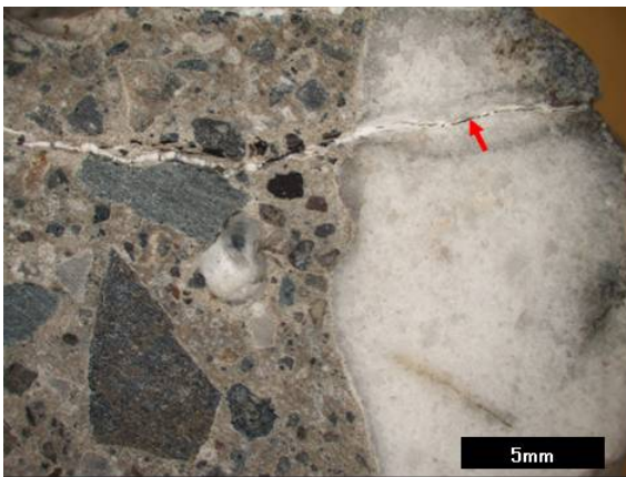
写真-10 珪質片岩(粗骨材)に生じたASRゲル(矢印)
