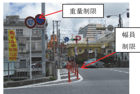
写真-5 重量及び幅員制限
