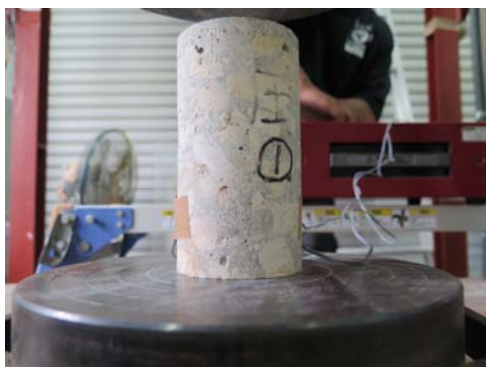
写真-4 圧縮試験用コアの1例
