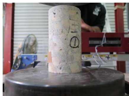
写真-5 コアの圧縮試験状況
