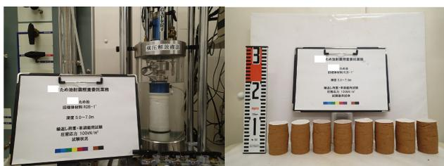
写真-2 繰返し+単調載荷試験状況写真
